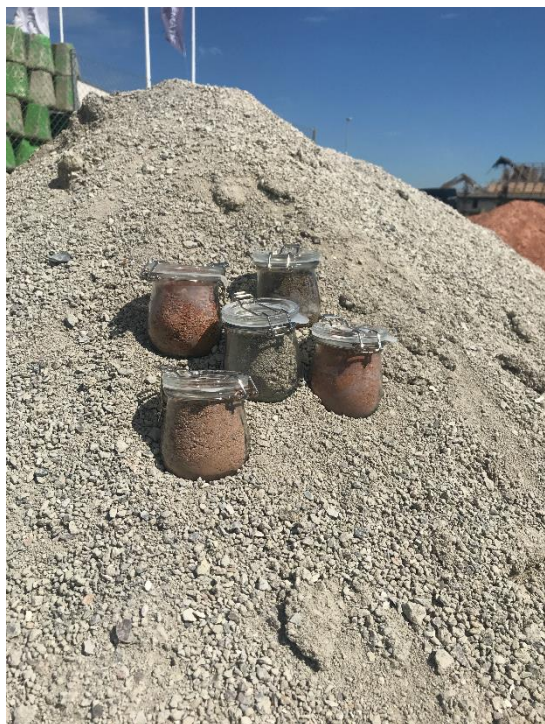
Figur 10. Som en del af forundersøgelsen blev der eksperimenteret med forskellige blandingsforhold af nedknust beton og tegl. (Foto: Martin Hedevang)
