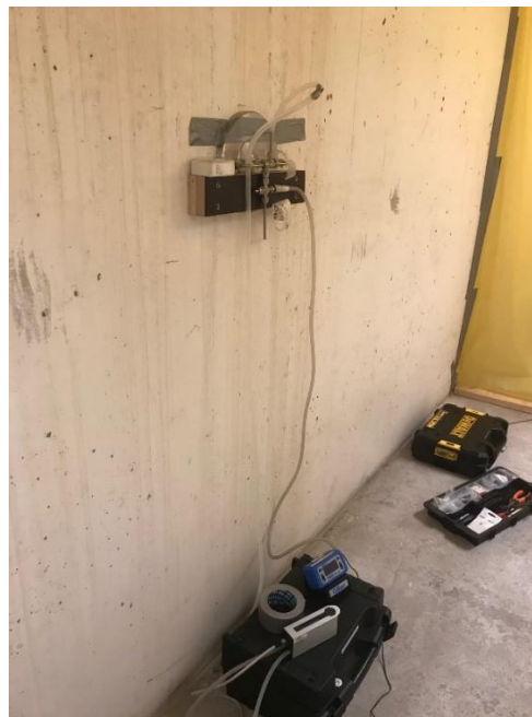
FLEC-måling på betonvæg
