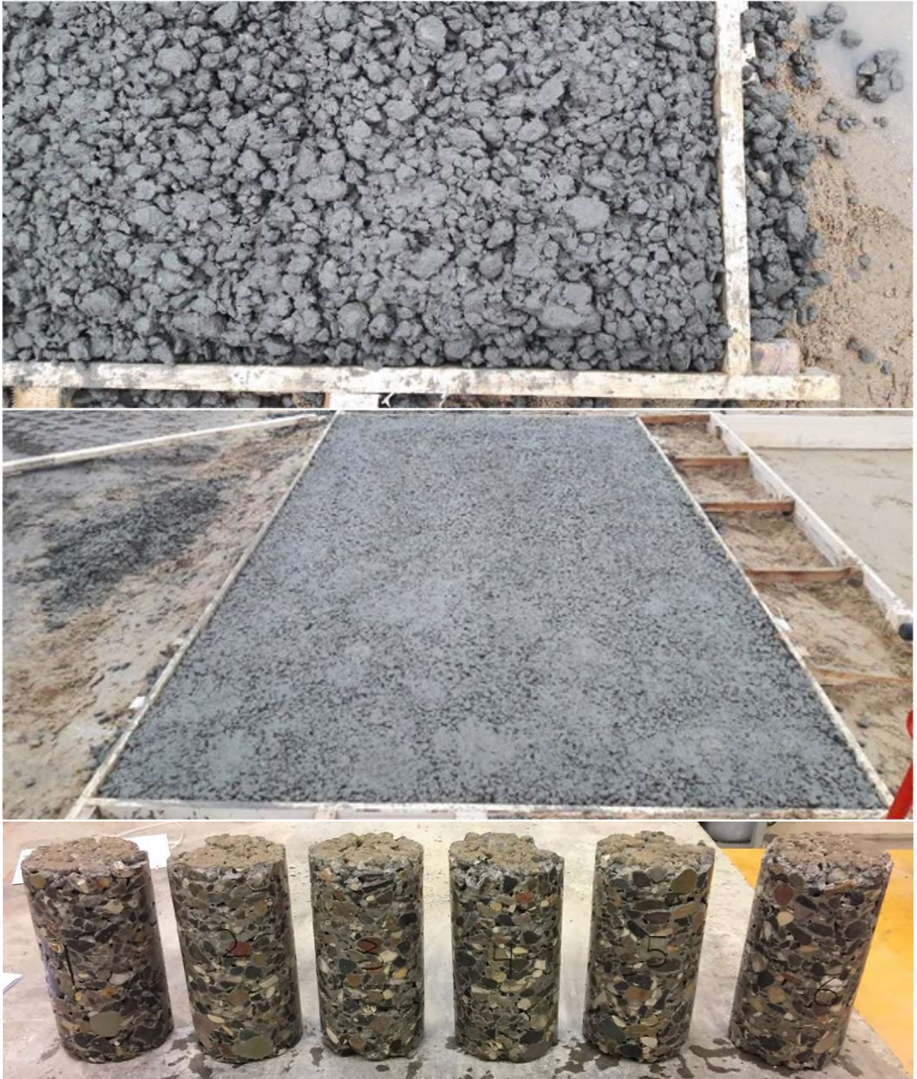
Figur 24 - Prøvefelt og udborede kerne for P32-U.
