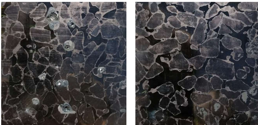
Figur 18 - Farvede planslib af E16-UL (til venstre) og E16-ML (til højre).
