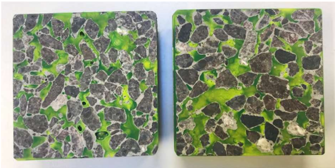
Figur 3 - E16-UL (til venstre) og E16-ML (til højre) indstøbt i epoxy, planet og poleret.
