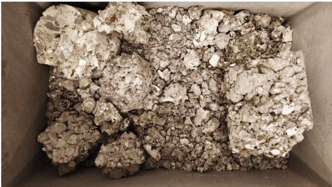
Figur 16 - P32-U, E16, P32-S og E25 efter frost/tø test i 3% saltopløsning på Danmarks Tekniske Universitet.
