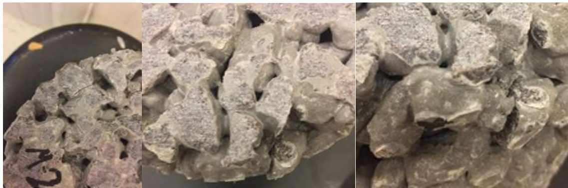
Figur 11 - Revnedannelse og tab af tilslag i E16-ML og E16-UL cylindere efter endt frost/tø test i rent vand.
