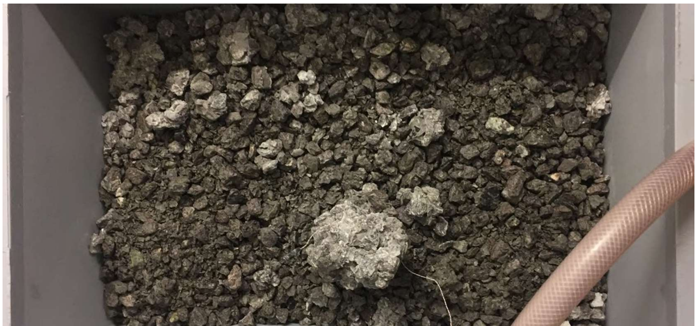
Figur 9 - E16-ML og E16-UL efter frost/tø test med saltopløsning på Danmarks Tekniske Universitet.
