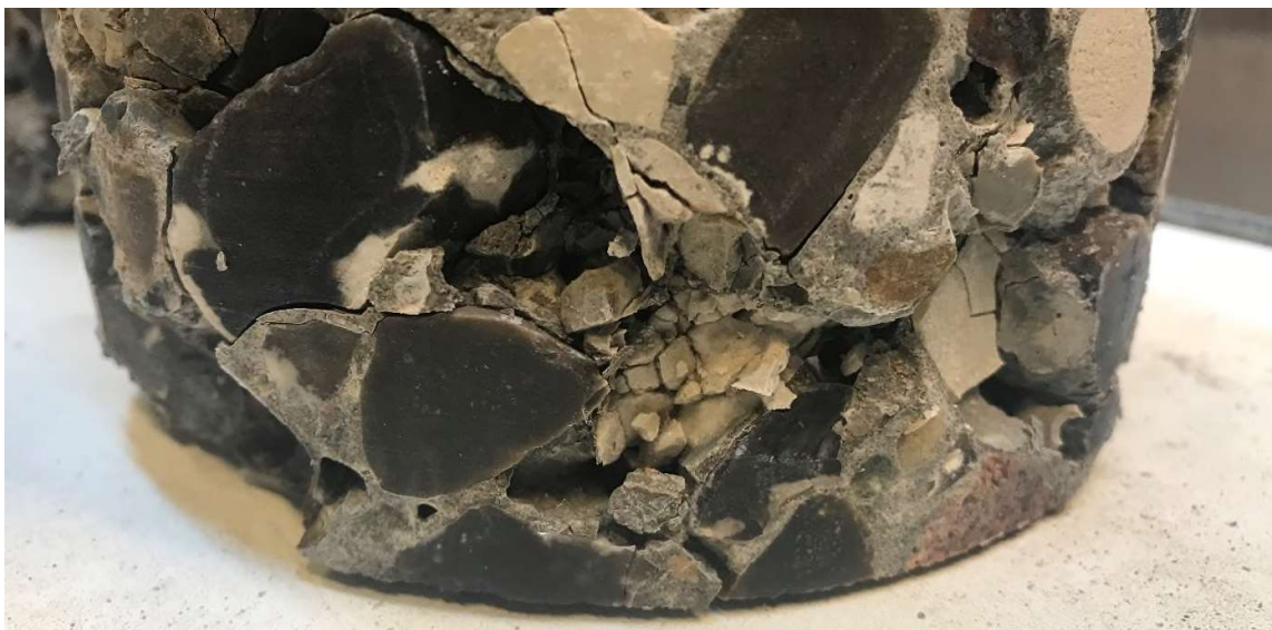
Figur 20 - Frostsprængning i en P-sten og omkring liggende pasta efter 9 frost/tø cyklusser på Teknologisk Institut.
