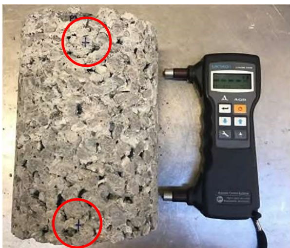
Figur 5 – Permeabel betoncylinder med markerede målepunkter og udstyr brugt til måling af ultralyd.
