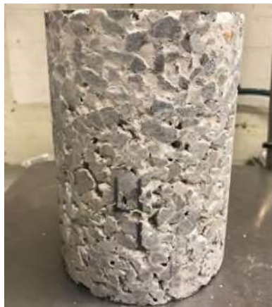
Figur 15 - Cylinder E16-4 med tydeligt indhold af borestøv i hulrummet.
