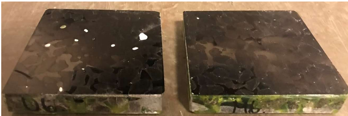
Figur 4 - E16-UL (til venstre) og E16-ML (til højre) klargjort til luftporeanalyse.
