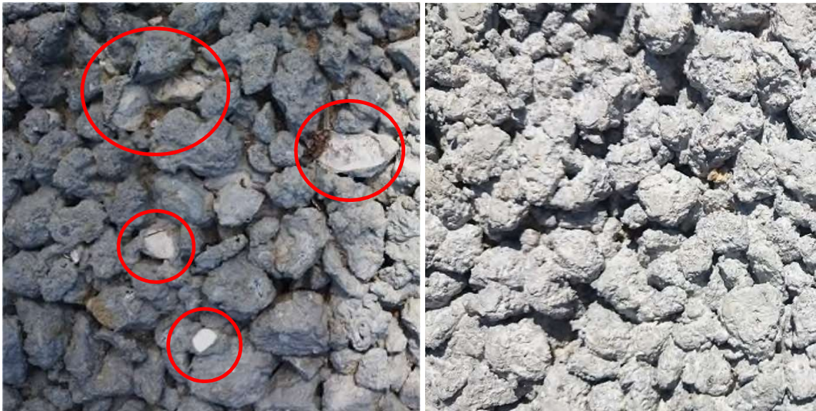
Figur 19 - Prøvefeltet med P-sten (til venstre) med synlige frostsprængninger i tilslaget og prøvefeltet med E-sten (til højre) uden synlige skader.
