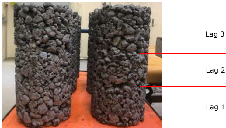
Figur 26 - Støbte cylindere set fra siden hvor støbelagene tydeligt fremgår.
