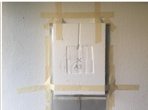
Figur 52: EPS udenpå folie på væg
