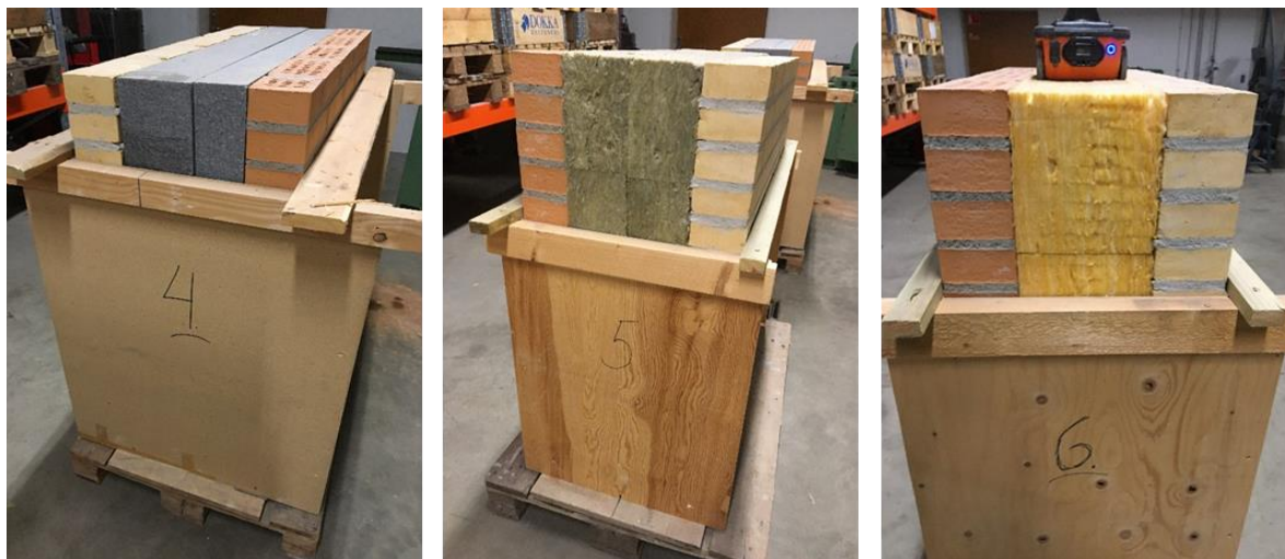
Figur 67: Brug af georadar på forskellige ydervægge
