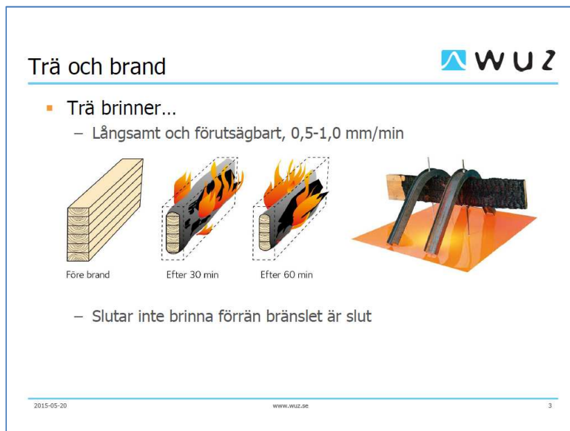
Figur 10: Figurene viser hvorledes bygningselementer af træ brænder og bidrager til branden i bygningen. Præsentation fra temadagen "Gentænk træ som bærende bygningsdele i høje bygninger", Fredrik Nystedt, WUZ.se
